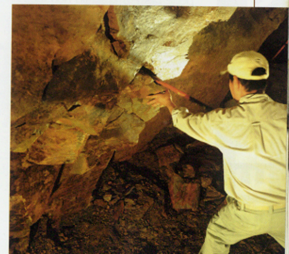
Tout est fait sans l'aide de moyens mécaniques : marteau et barre à mine.
