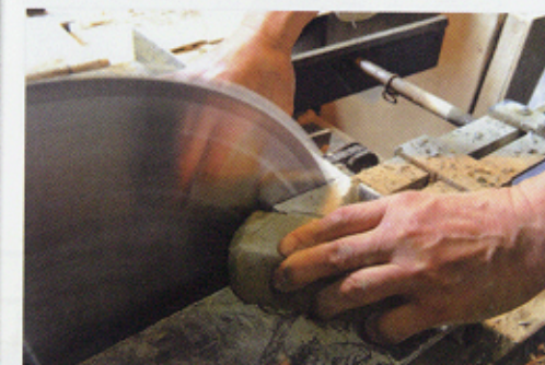
Délicate opération de calibrage, à la scie circulaire (ikishij).
