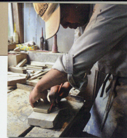
Délicate opération de calibrage, à la scie circulaire (ikishij).
