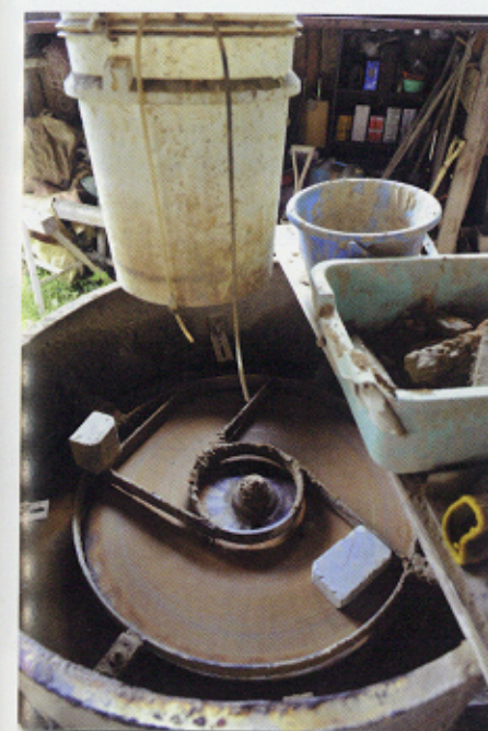
Polissage par inertie sur le «enban», à l'aide de poudre d'émeri.
