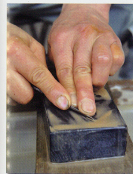
Préparation de la « boue », à l'aide d'une nagura : la lame accrochera mieux sur la pierre dure.
