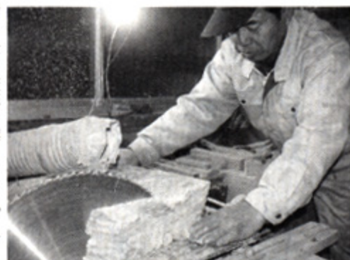
原石が大きいので、丸鋸へ向けて体重を乗せるようにする
